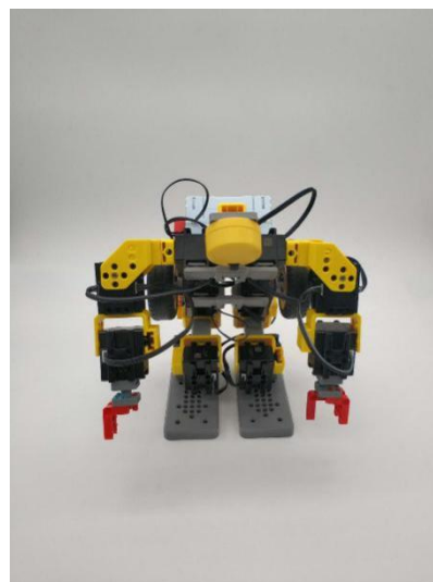
Рис. 11.11 Робот приседает, в результате чего его центр тяжести смещается вниз
