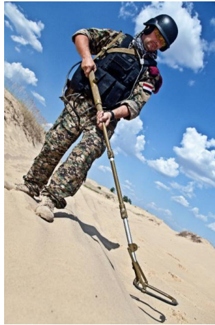
Рис. 13.3 Разминирование с помощью металлоискателя
