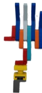
Рис. 5.15 Компоненты, необходимые для сборки кисти Рис. 5.16 Структура кисти
